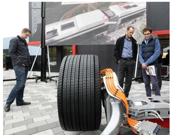
L'essieu conçu dans les bureaux R et D de Lohr est de forme classique, avec de la connexion électrique en plus.
